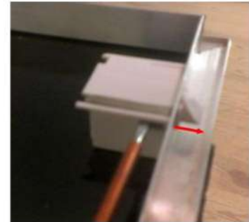
3 / Exercez un mouvement horizontal allant de gauche à droite avec le tournevis plat sur la languette métallique présente dans l'espace. Le loquet se remet en position sortie. Effectuez cette opération sur les 4 boîtiers.
